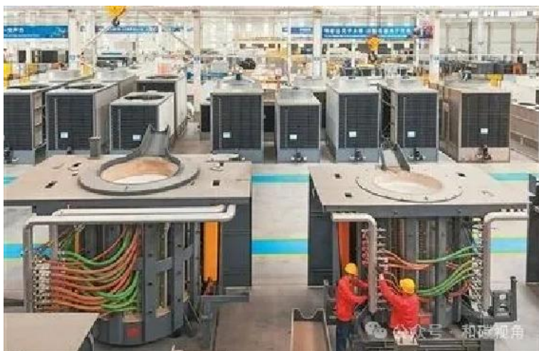
在位于河南省洛阳市汝阳县的一家智能设备生产企业，工人装配节能感应熔炼炉。 李卫超摄（人民视觉）
